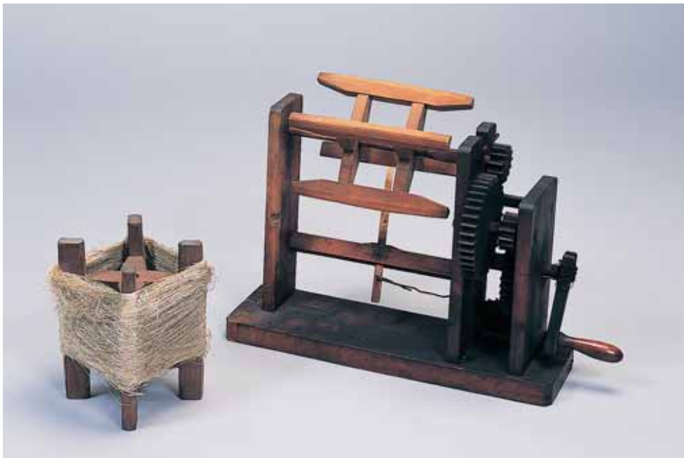
座繰 (幅54cm、奥行13cm、高さ40cm) と小枠 (写真左、直径16.5cm) 家庭で糸を繰る時には、座繰と呼ばれる糸繰器が使われていました。ハンドルを回すと、小枠 が回転して糸を巻き取ります。
